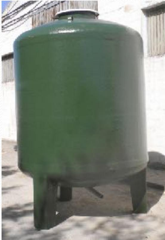
Los depósitos verticales con patas (modelos DVP) son para colocar en superficie y disponen en su parte superior de una boca de hombre circular de 450 ó 600 mm de diámetro y dos anillas de izado para carga y descarga. La situación y diámetro de las conexiones de llenado y vaciado serán opcionales.
